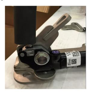
Inboard (tunnel side) seat belt mount.
